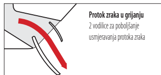
Idealni odvod protoka zraka u grijanju
